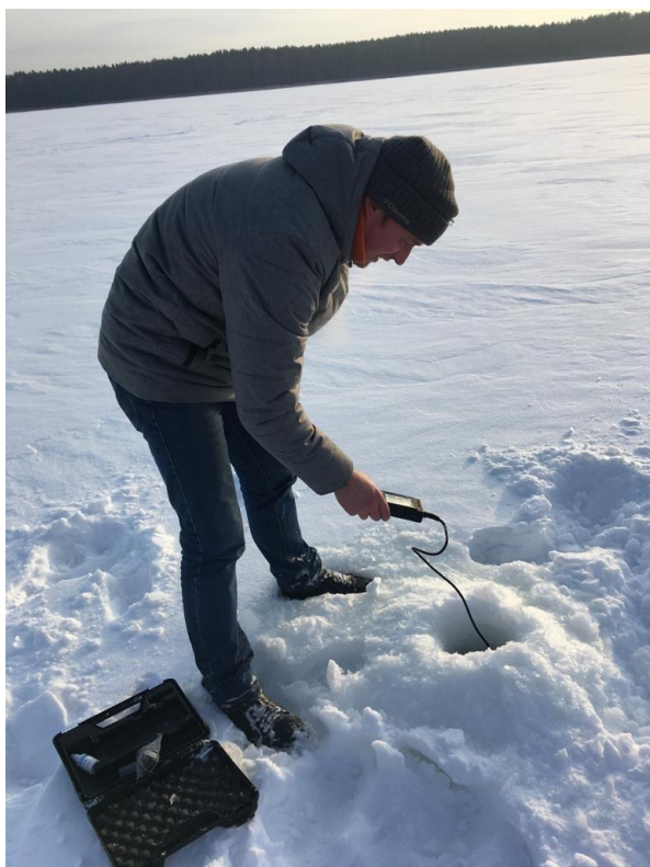
Рисунок 1 – Измерение растворенного кислорода
